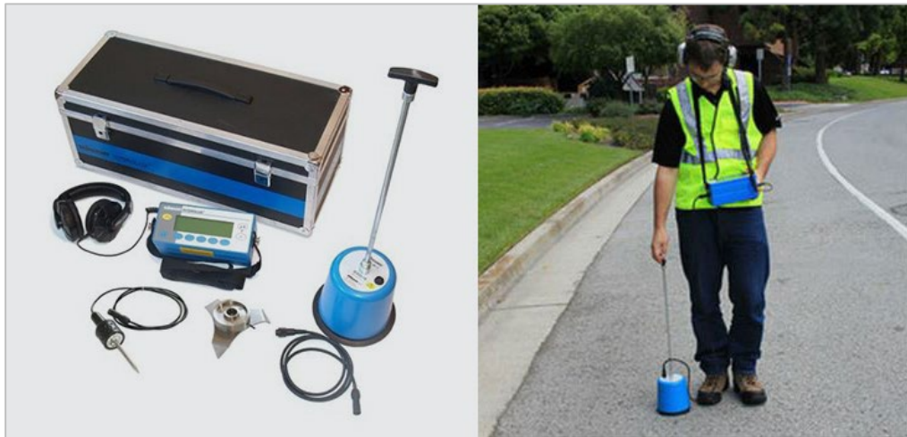
Figure 4.14. Acoustic leakages localisation using Hydrolux HLE 5000 (data from AB Vilniaus šilumos tinklai)
